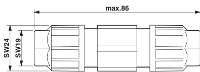
Kablo konektörü, QUICKON bağlantı: 0.75 mm 2 ... 1.5 mm 2
