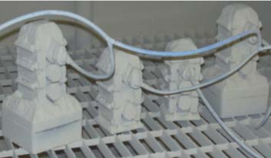
Resim IP6x toz testinde DUPLICON test numunesini göstermektedir.
