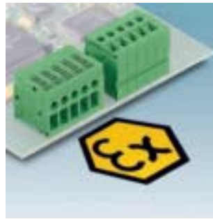
Yatay ve dikey önden bağlantılı PCB klemensleri, 5,0 mm pin aralığı, 2,5 mm 2 bağlantı kesiti FRONT 2,5/...-EX
