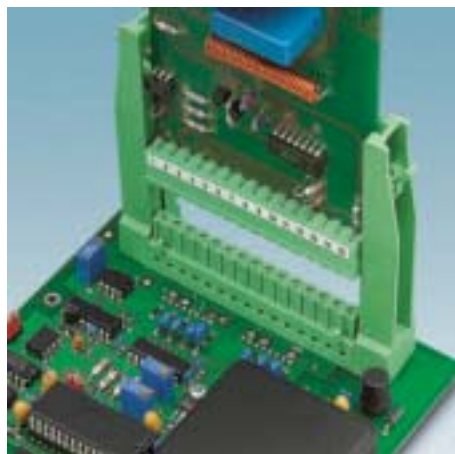
4. Birincil/ikincil PCB bağlantıları için ICV 2,5 versiyonları ve MSTB 2,5 soketleri. FLRP yan kılavuz kızakları bu durumda ikincil PCB'yi stabilize etmek için kullanılır.
