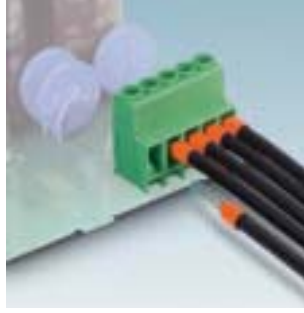
MKDS 5 HV serisi: Vidalı bağlantı, 41 A'e kadar, 6.35 mm / 9.52 mm pin aralığı, 600 V UL MKDS(V) 5 HV/... Sayfa 317
