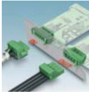
PC 16 serisi: Geçiş konnektörü, lehimli bağlantı, 76 A'e kadar, 10.16 mm pin aralığı DFK-PC 16/...
