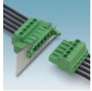
PC 5 serisi: Geçiş konnektörü, 41 A'e kadar, 7.62 mm pin aralığı DFK-PC 5/...
