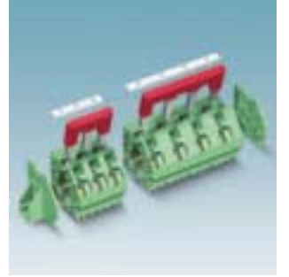
ZFKDS 10 serisi: Yaylı bağlantı, 76 A'e kadar, 10 / 15 mm pin aralığı ZFKDS 10/... Sayfa 347
