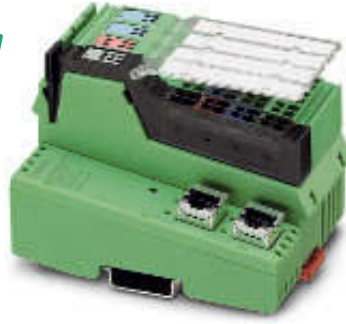
2 port bakır bağlantı, 8 dijital giriş ve 4 dijital çıkış
