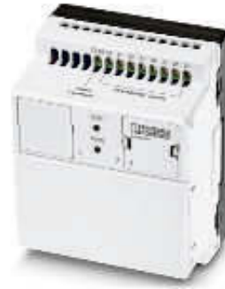
24 V DC, 8 dijital ve 2 analog giriş, 4 röle çıkış
