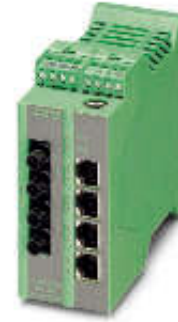
ST formatında 4 RJ45 port ve 2 SM FO port
